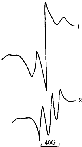
图 5 P_1 在 PP 膜中产生的 ESR 信号光氧化 44 小时
